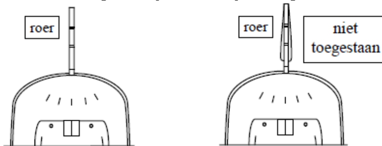
Fig. 5 - Doorsnede traditioneel roer
